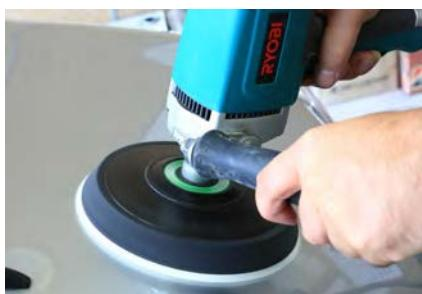
パッドの中に挟み込まれた反発性特殊板がポリッシング時に発生するバタつきを抑え、また軽量で且つ低重心化による3つの効果でポリッシャー本体が暴れる事を防ぎ、塗膜にバフをあてる感触がダイレクトに伝わる高い操作性と安定したポリッシングを可能にします。
